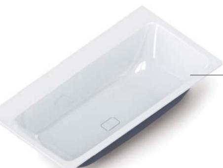
カルデバイのホーローは陶磁器などと同じ「やきもの」です。七宝のように金属製の下地に釉薬を高温で焼き付けたもので、焼き付けられた釉薬はガラス質となります。艶やかな輝きとなめらかな肌触り、高い表面硬度による耐摩耗性、金属の強度を併せ持つ複合素材です。
