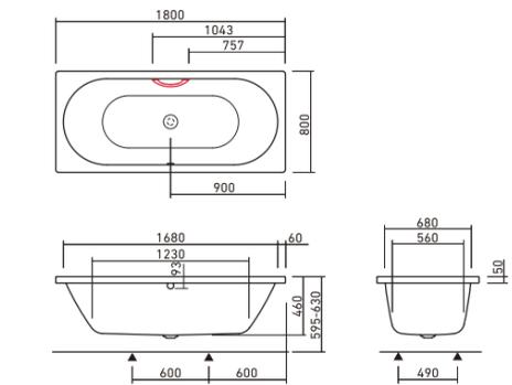
•特に表示のない表記寸法単位はmmです。 •容量はオーバーフローまでの水量です。 •▲は設置用脚位置です。 •バス用ポップアップ排水金具 / 設置用脚付属 (図面) P.87
